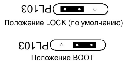
Рисунок 19: положения джампера сектора загрузки
