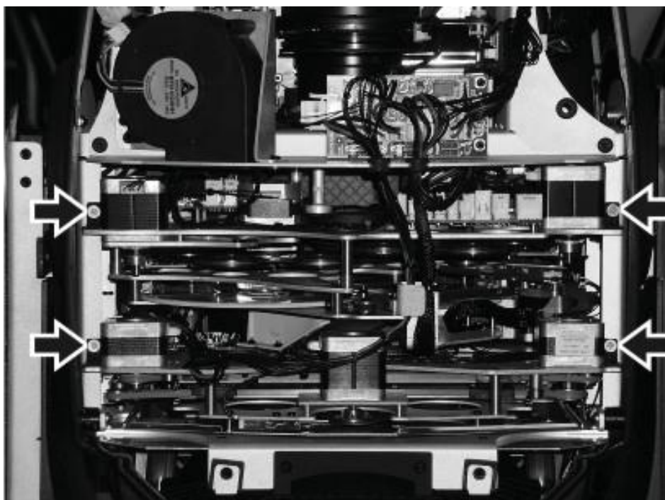
Рисунок 27. Крепежные винты модулей
