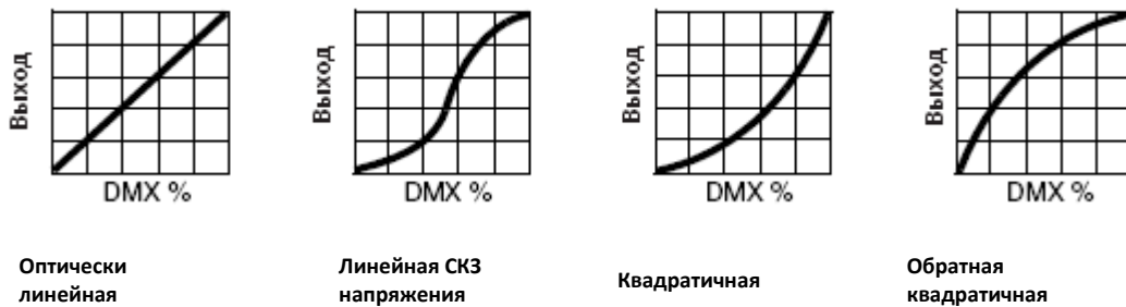
Рисунок 11. Варианты кривых диммирования
