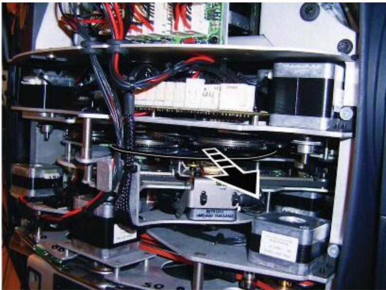
Рисунок 25. Снятие колеса анимации
