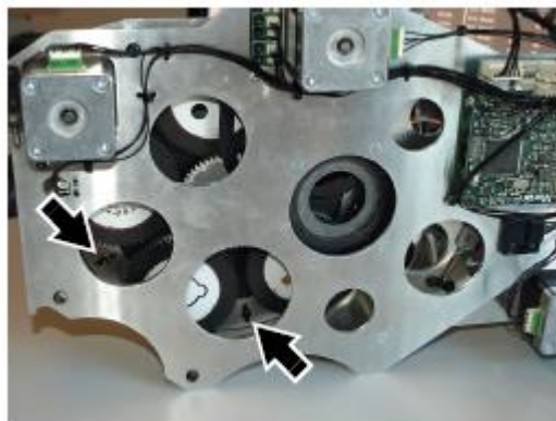
Рисунок 22. Крепежные винты держателя гобо
