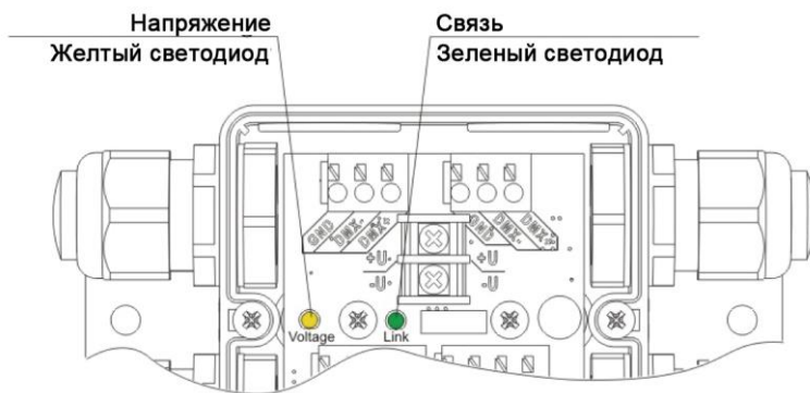
Рис. 34. Светодиоды индикатора состояния в сплиттере
