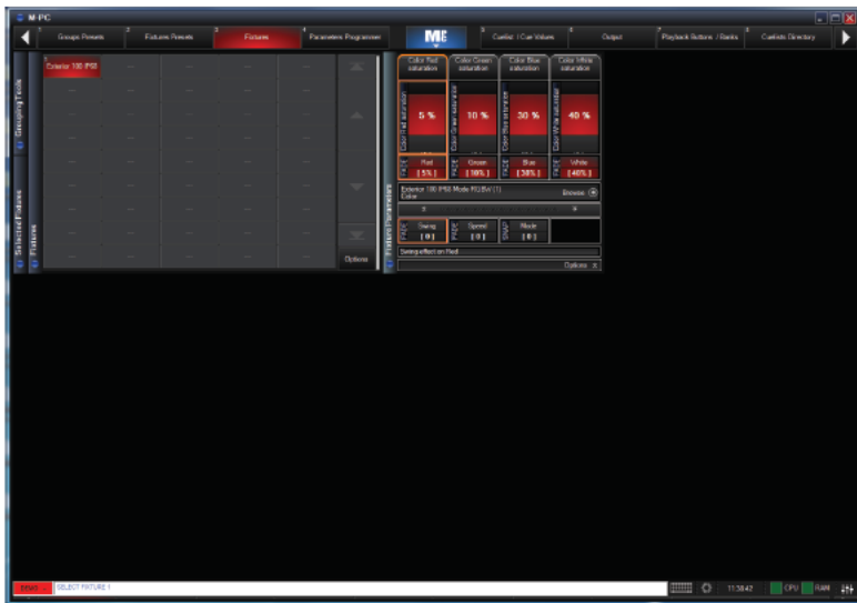
Рис. 41. Интерфейс управления по DMX-каналу через приложение M-PC
