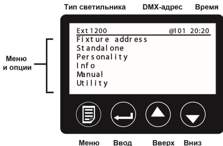
Рис. 12. Панель управления и ЖК дисплей.
